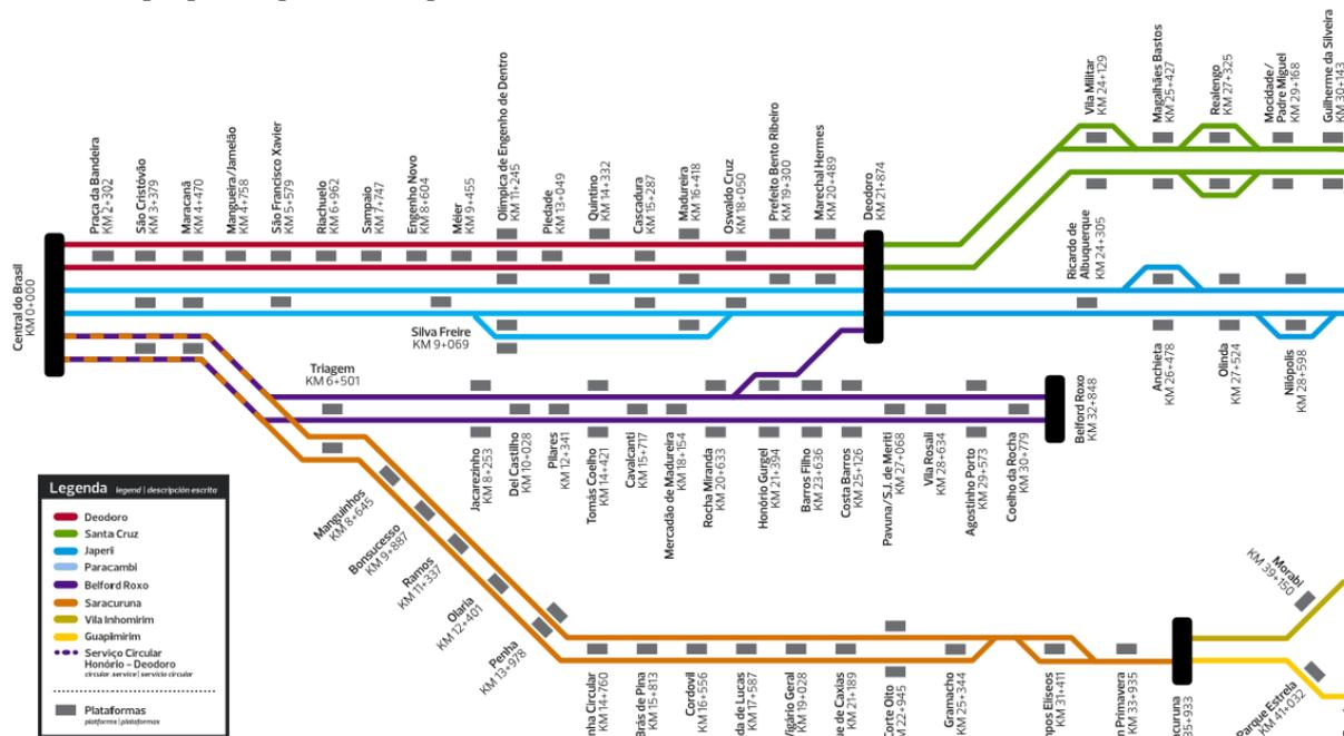
Figura 3-1 - Diagrama esquemático de vias entre as estações Central do Brasil e Deodoro na proposta apresentada pela Concessionária.
