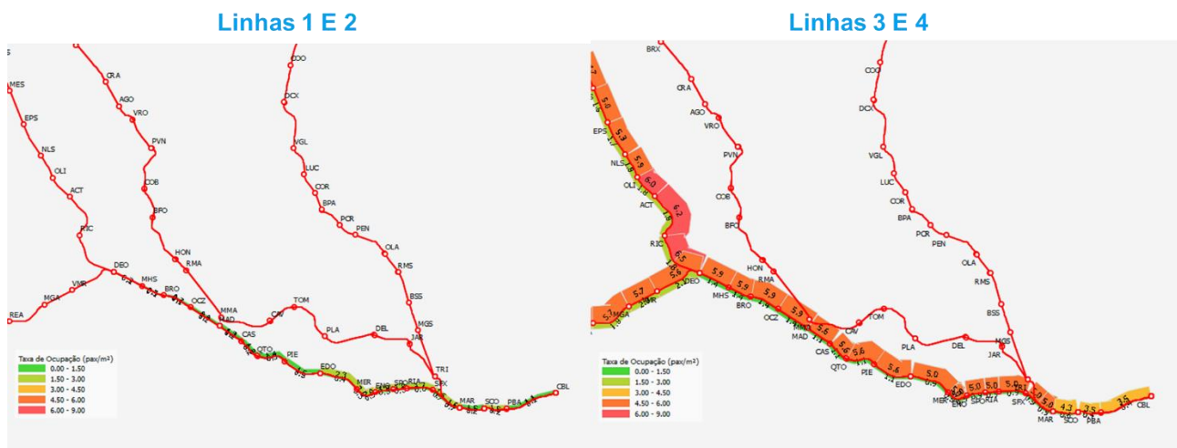
Figura 1: Taxa de ocupação da Hora 17, para o período Pré-COVID, por trecho entre estações para os diferentes pares de linhas existentes entre Central e Deodoro (Estimativa com base em simulação da rede no software EMME/4).
