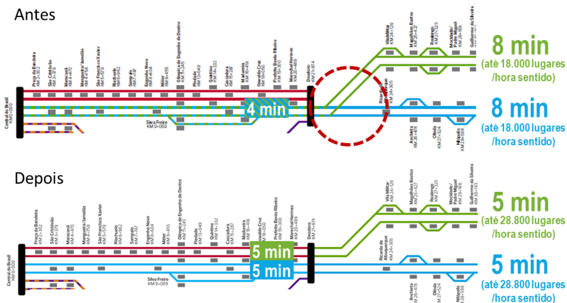
Figura 2: Capacidades máximas dos modelos operacionais Pré-COVID e do novo modelo operacional, com a interligação dos ramais Santa Cruz e Deodoro
